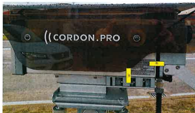
Slika 8. Prikaz postavljanja zaštitnih oznaka u obliku naljepnice koje sprečavaju neovlašteno otvaranje kućišta mjerila
