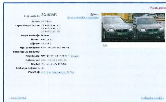
Slika 6. Pregled utvrđenih slučajeva prekoračenja brzine te prikaz detalja detektiranog prekršaja na zaslonu računala
